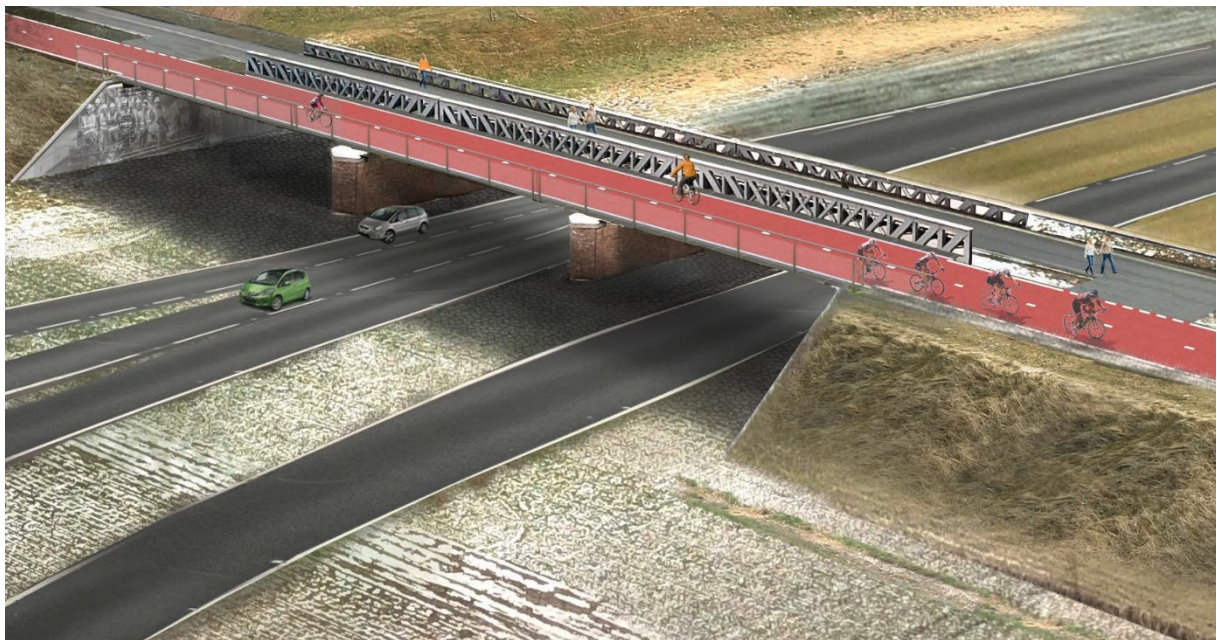
Brug over de afslag naar de A59 met schets van de nieuw aan te leggen brug voor snelfietsroute
